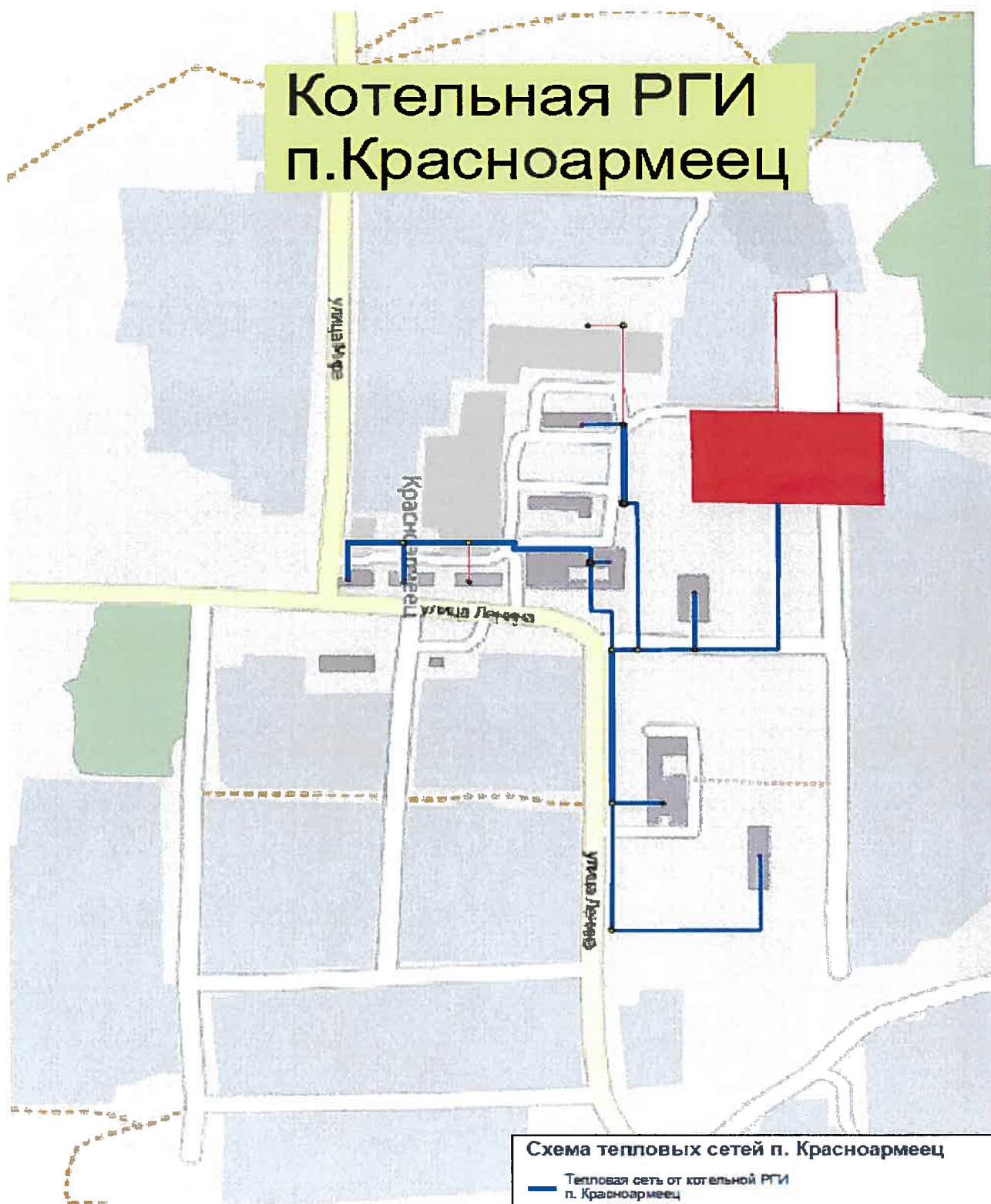
Рисунок 4 - Зона действия котельной пос. Красноармеец
